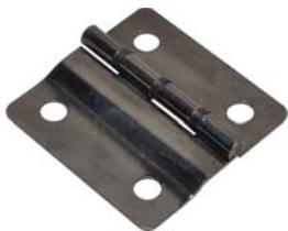
Falлтürscharnier, gekröpft Ausführung, 50 x 50mm, Stahl schwarz verzinkt
